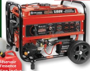
Comprend câble de raccordement au réservoir de propane
